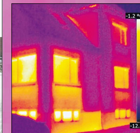
Det ser ud som om, der er lys i huset her i Kompagnigade i Skive. Det er der ikke. Varmetab giver de lyse partier.
